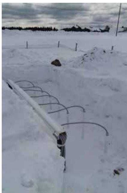
*Вытяжные термометры «Терра-Т» — после установки*
