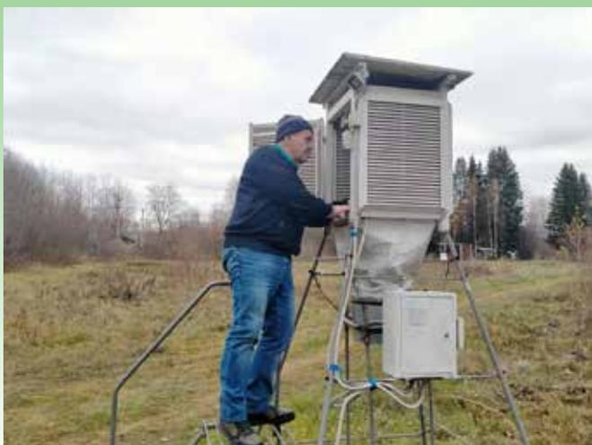
*Корзунин А.П. снимает показания из аэрологической будки А-51*
