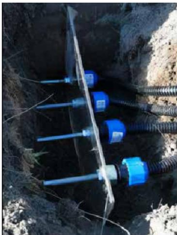
*Установка датчиков температуры почвы ТСПТ 300 на глубинах на оголенном участке в планшет из стеклотекстолита*
