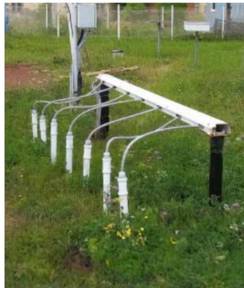
*Установка с датчиками температуры грунта на участке под естественным покровом*
